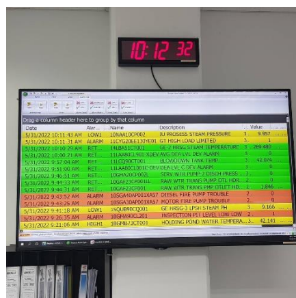
รูปที่ 3 หน้าจอร์บบ DCS และการตั้งเตือนที่หน้าจอ
