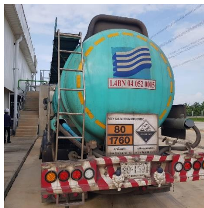
รูปที่ 26 สัญลักษณ์ รหัสแสดงอันตรายของสารเคมี และเครื่องดับเพลิงแบบมือถือ บนรถบรรทุกสารเคมี และการจัดเตรียมเครื่องดับเพลิงแบบมือถือขณะขนถ่ายสารเคมี
