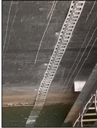
รูปที่ 21 อุปกรณ์แสดงระดับน้ำของแม่ข่ายแม่กลองที่บริเวณสถานีสูบน้ำ
